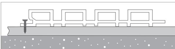
Instalação sobre suporte de viga de fixação, fixa à parede.
