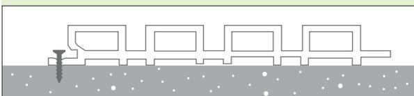
Instalação sobre suporte de alvenaria ou outro suporte para fixação direta por parafuso.
