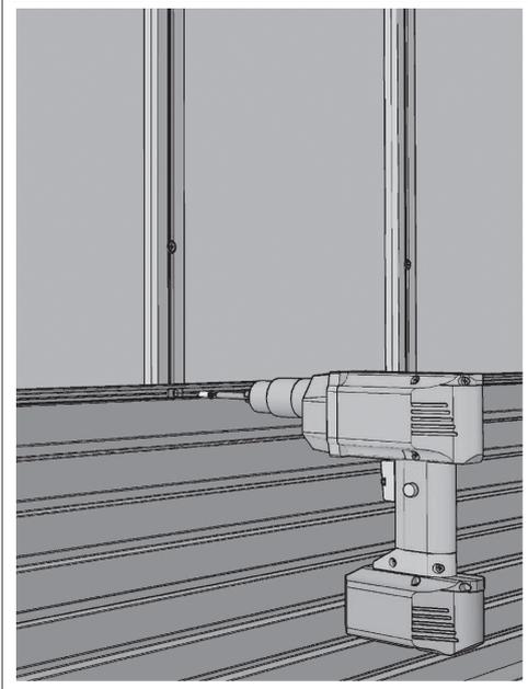
6 ACABAMENTO - COLOCAÇÃO E FIXAÇÃO DA PLACA dk-wall®
